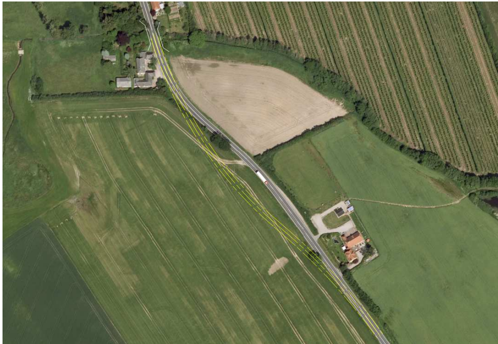
Figur 23 Skitse. Udretning af sving på Bøgebjergvej/Faaborgvej
