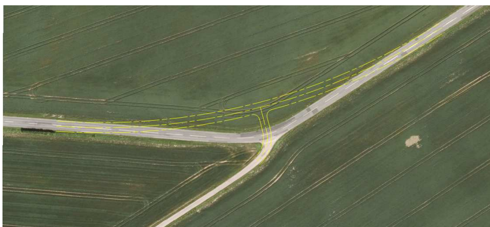
Figur 32 Skitse. Udjævning af kurve på Gestelevvej
