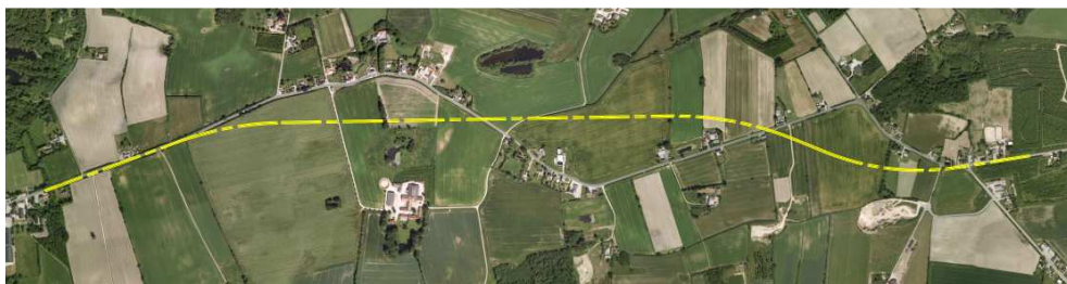
Figur 26 Skitse af ny linjeføring for Assensvej imellem Hillerslev og Espe
