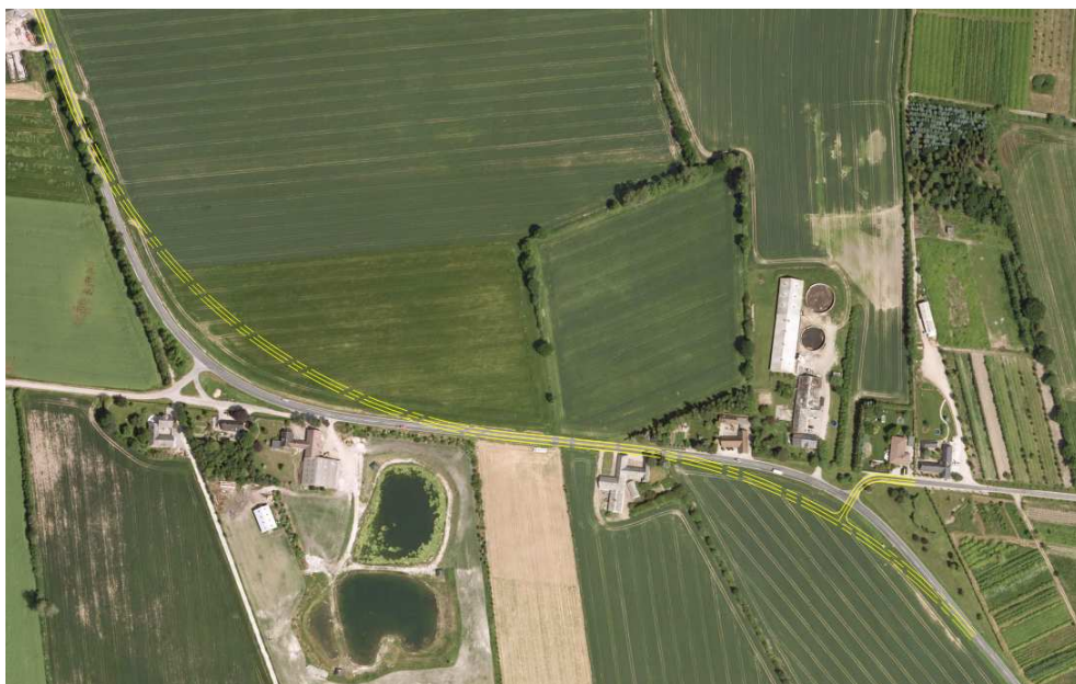
Figur 30 Skitse. Udretning af kurver på Snarupvejen
