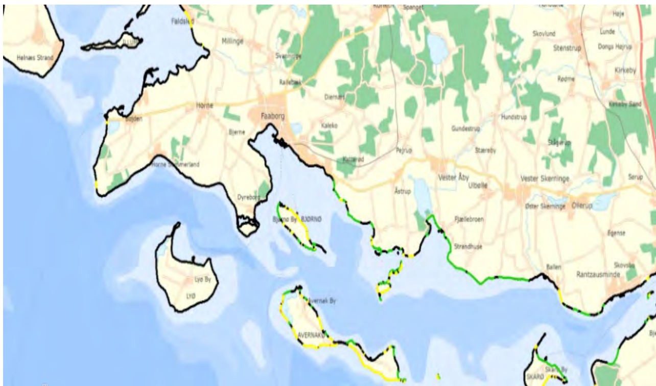
Udskrift fra Kystatlas.dk., visende kronisk erosion. Sort: Lille erosionsrate. Gul: Moderat erosionsrate.
