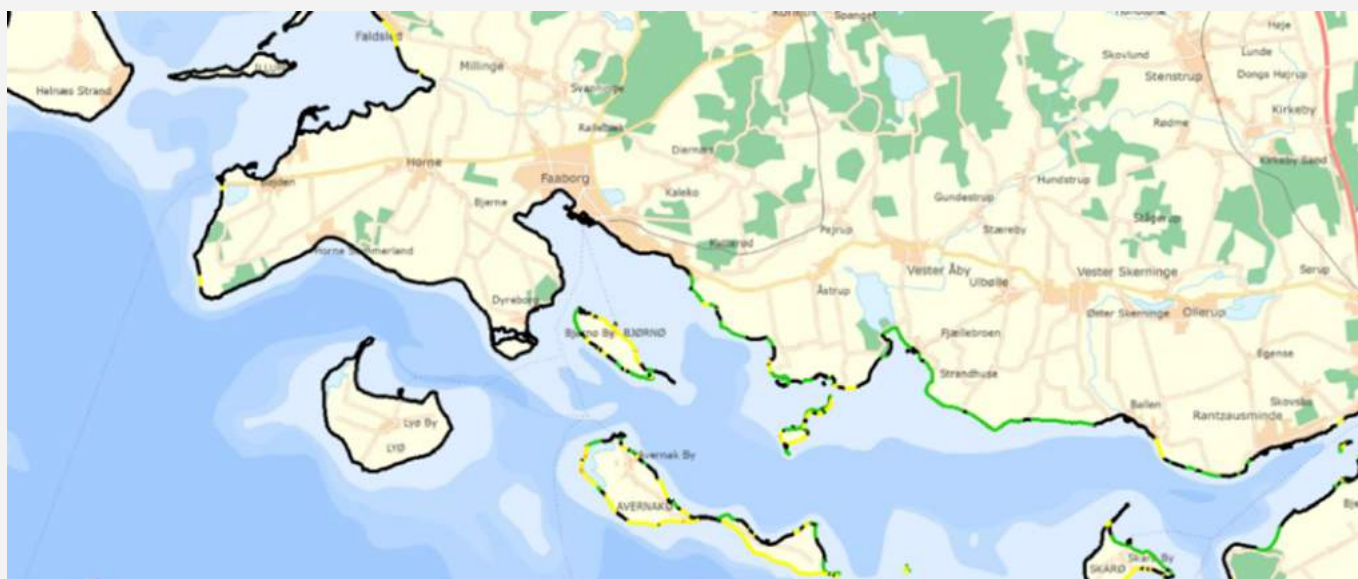
Udskrift fra Kystatlas.dk., visende kronisk erosion. Sort: Lille erosionsrate. Gul: Moderat erosionsrate.
